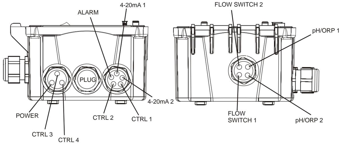
**Figure 2e WDP440 Conduit Wiring**
